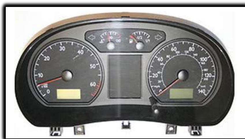
Figura 10 – Cluster com unidade do imobilizador incorporado internamente.
