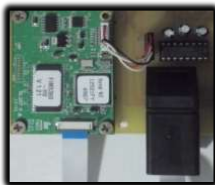
Figura 54 – Conexão do módulo FIM5360 com o MAX232
