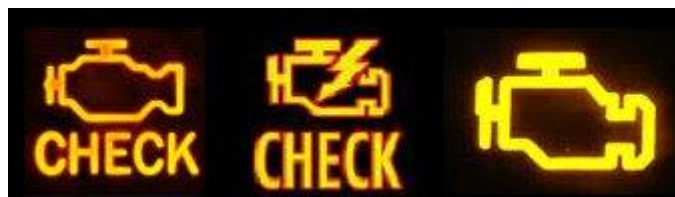
Figura 25 - Lâmpada Indicadora de Falhas(LIM) [EXTRAIDO DE DENTON, 2004].
