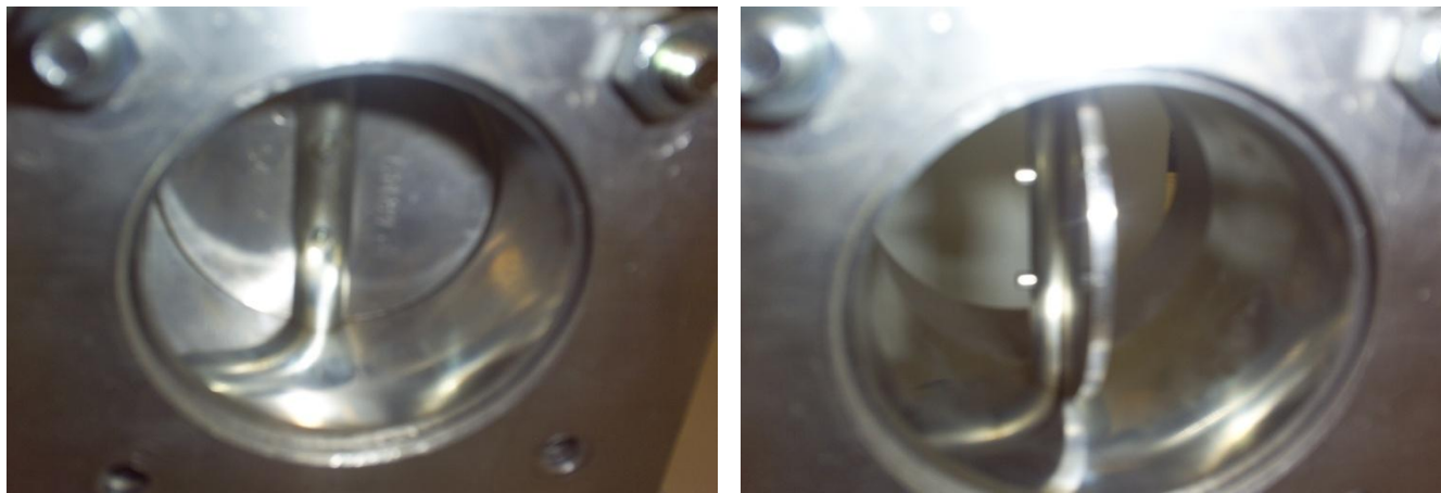
Figura 67 - Válvula Borboleta Fechada e com 100% abertura.
