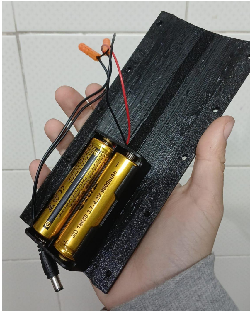
Figura 07 – Bateria externa fixada na tampa da base
