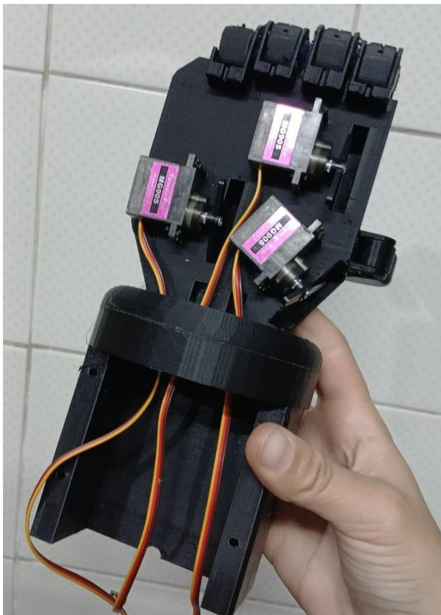
Figura 06 – Micro servomotores integrados ao sistema
