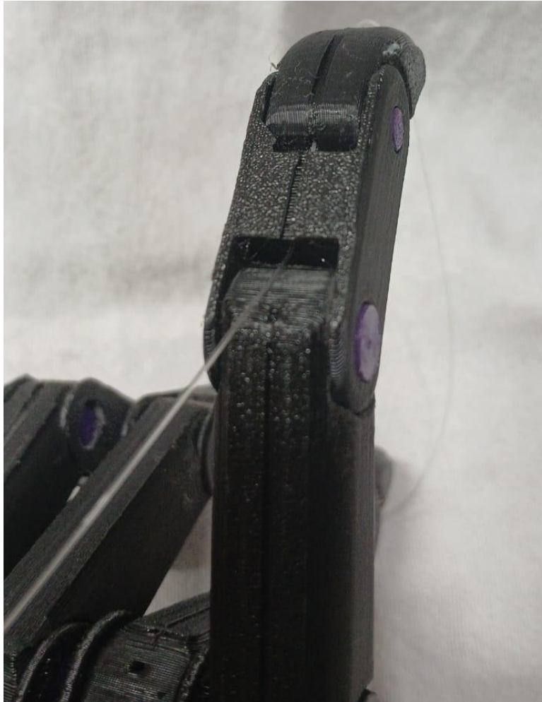
Figura 10 – Canaletas internas e externas para passagem dos fios de nylon
