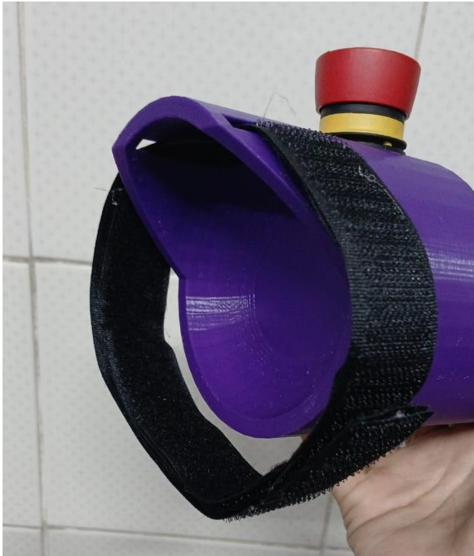
Figura 04 – Fita velcro de ajuste
