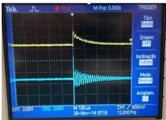
Figura 55 - Comparativo entre os sinais do pulso de ignição retificado e do pulso de ignição não tratado do pulso de ignição
