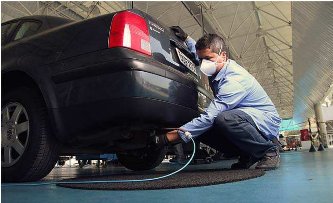
Figura 25 - Técnico da CONTROLAR instalando a sonda para a leitura dos gases (Extraído de < http://www.sempretops.com/informacao/controlar-inspecao-veicular-2012-inscricoes/ > acesso em 28 de maio de 2014)
