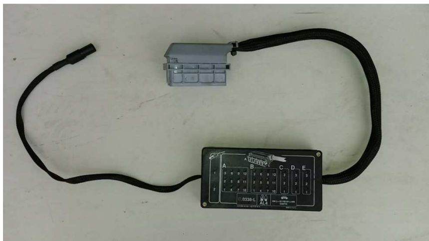
Figura 65 - Derivador utilizado para medições em Caixas de Velocidades Automáticas
