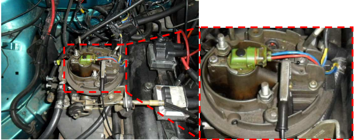
Figura 67 - Medição do sinal através dos bornes do conector do injetor
