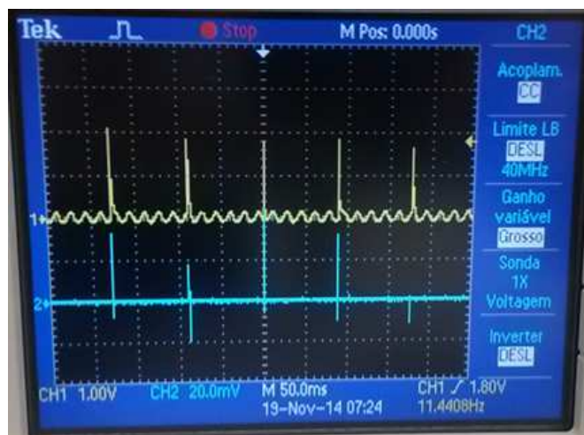
Figura 78 - Comparativo entre os sinais após o tratamento pelo circuito projetado e o sinal de entrada
