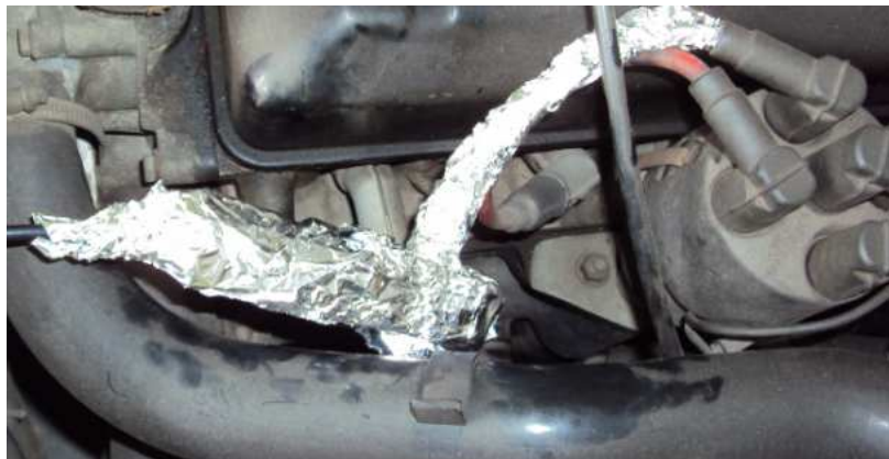
Figura 32 - Tentativa de blindagem - Pinça + Cabo de vela
