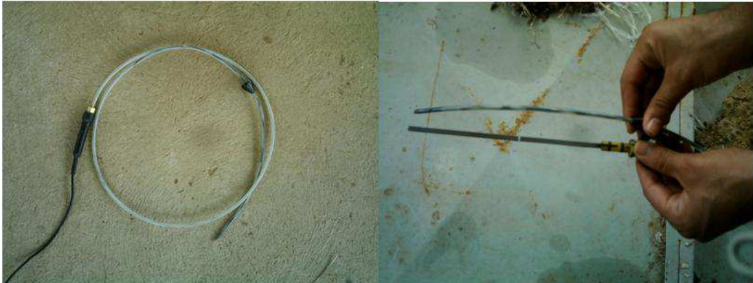
Figura 26 - Sonda de temperatura do óleo do motor (Extraído de < http://www.rcmodelxtreme.com/product.php?id_product=607 > acesso em 28 de maio de 2014)
