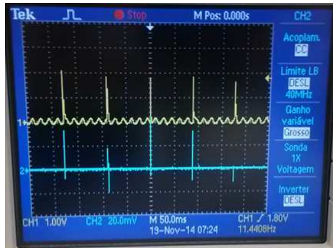
Figura 58 - Comparativo entre os sinais após o tratamento pelo circuito projetado e o sinal de entrada
