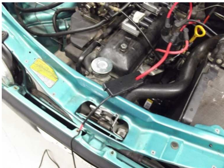
Figura 28 - Pinça indutiva instalada no cabo de vela número 1
