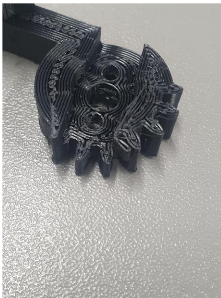
[Erro nas engrenagens da garra]
