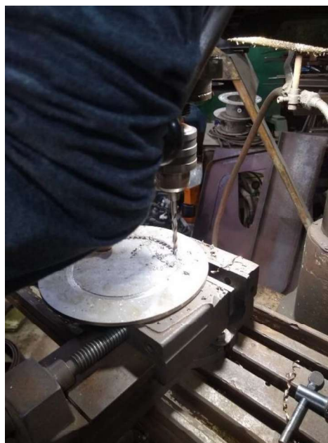
Figura 33 – Furação da flange
