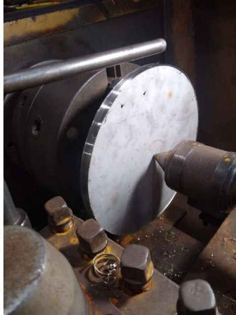
Figura 48 –Torneamento da Tampa
