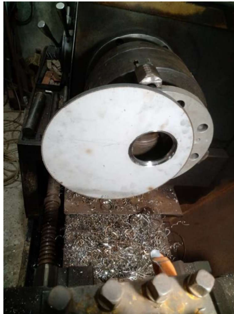
Figura 42 – usinagem da tampa
