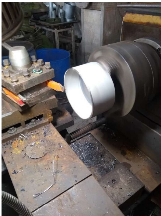
Figura 41 – Usinagem do Tubo
