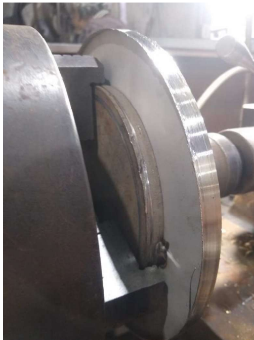
Figura 47 –Fixação da tampa no torno
