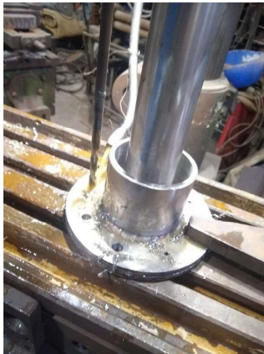
Figura 54 –Furação do flange
