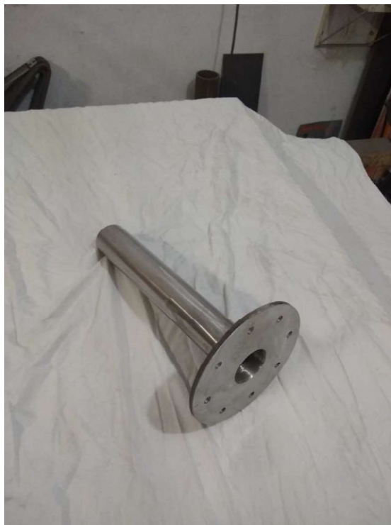
Figura 57 –Tubo do Queimador Finalizado
