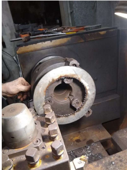
Figura 34 – Torneamento da peça furada
