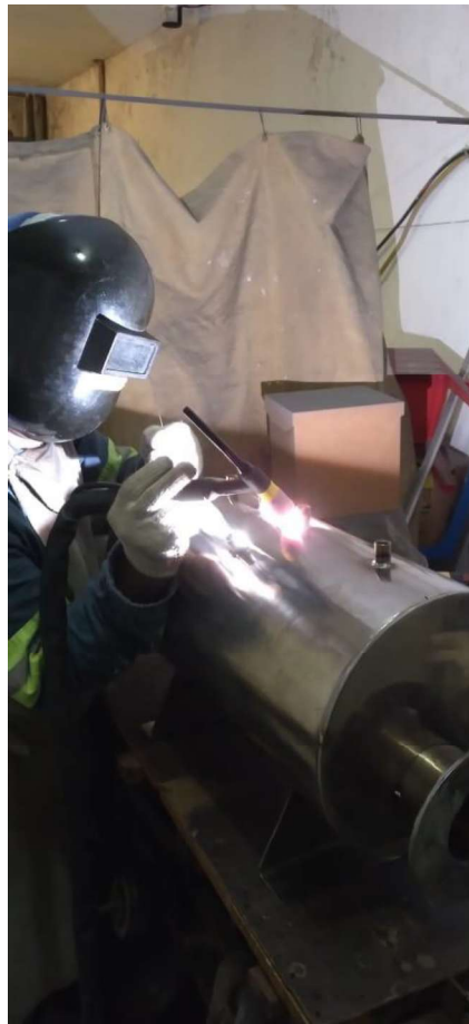
Figura 60 – Soldagem dos componentes
