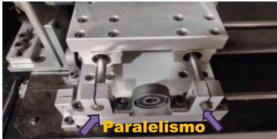
Figura 5 – Alinhamento e paralelismo dos guias lineares Fonte: Elaborada pelo autor.
