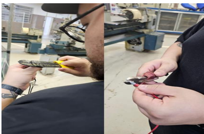
Figura 43: Prensando terminal do cabo do painel elétrico.
