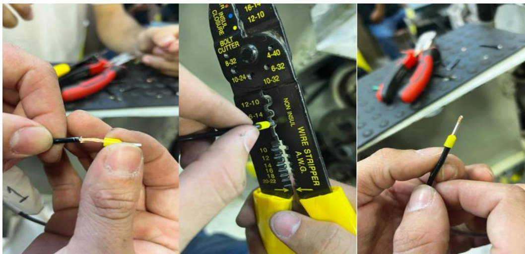
Figura 40: Prensando terminal dos cabos.
