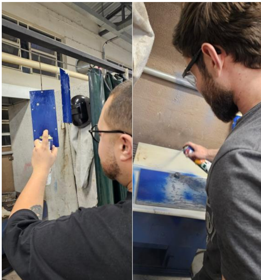
Figura 18: Pintura da caixa do painel.
