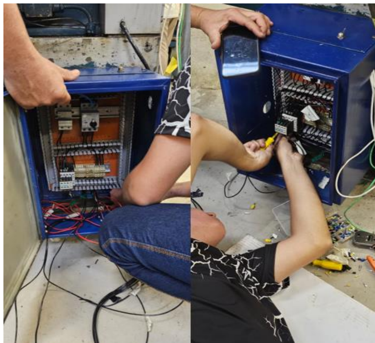
Figura 45: Ajustes finais com o painel fixado no torno.
