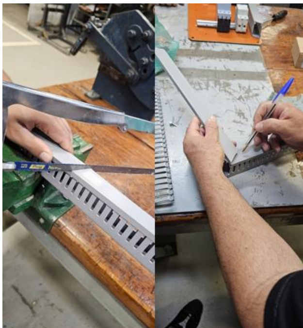
Figura 30: Medindo e cortando canaleta.
