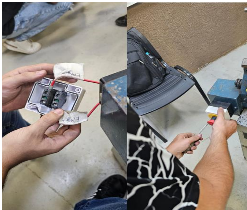
Figura 34: Cabeando e parafusando o botão de emergência.
