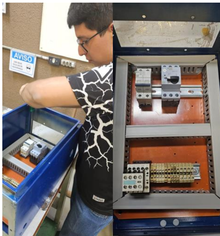
Figura 37: Fixando painel na caixa.
