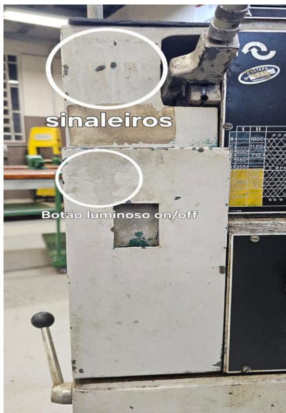
Figura 12: Ponto de instalação do botão e sinaleiros.
