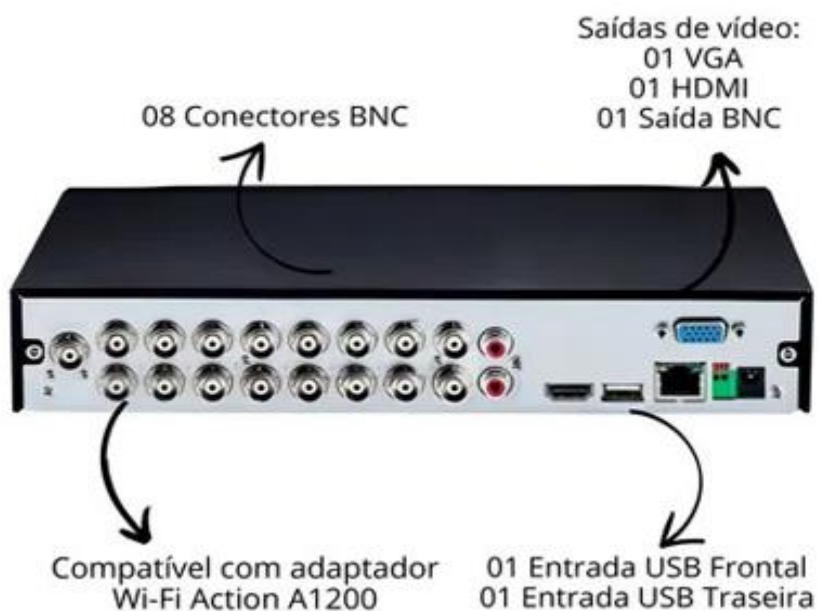
Figura 15: Visão traseira do DVR e das entradas e saídas FONTE: Do Próprio Autor, 2025
