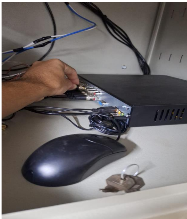
Figura 14: Conexões das entradas e saídas de vídeo e áudio FONTE: Do Próprio Autor, 2025
