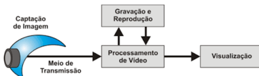
Figura 1: Blocos básicos do CFTV
