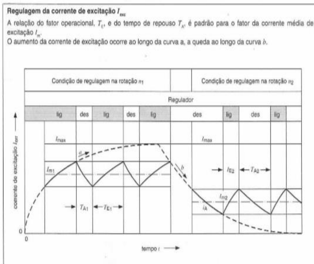
Figura 16 Regulagem da corrente de excitação [Extraído de (BOSCH 2001/2002) pág. 15]
