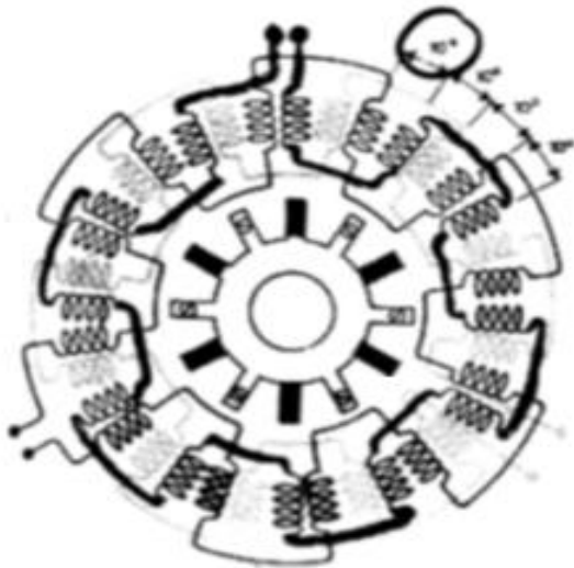
Figura 6 Ligação das bobinas do estator [Extraído de (ALVES e LOURENÇO, 2009), pág.14]
