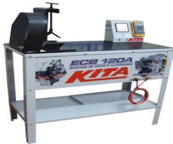
Figura 17 Bancada de teste de alternadores [Extraída de (KITACARREGADORES.COM.BR, 07-2014)]
