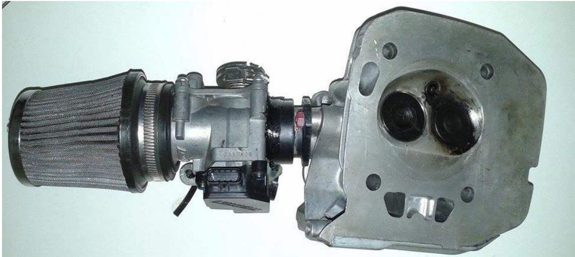
IMAGEM 57 - TBI INSTALADA AO CABEÇOTE
