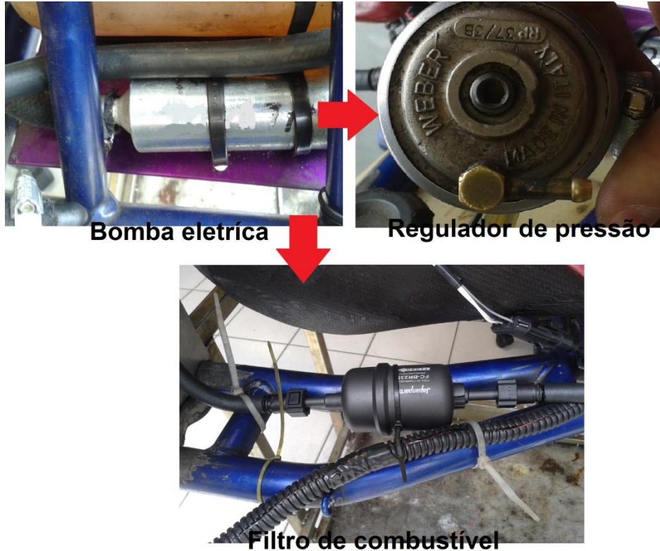
IMAGEM 59 – BOMBA ELÉTRICA – REGULADOR DE PRESSÃO – FILTRO DE COMBUSTÍVEL
