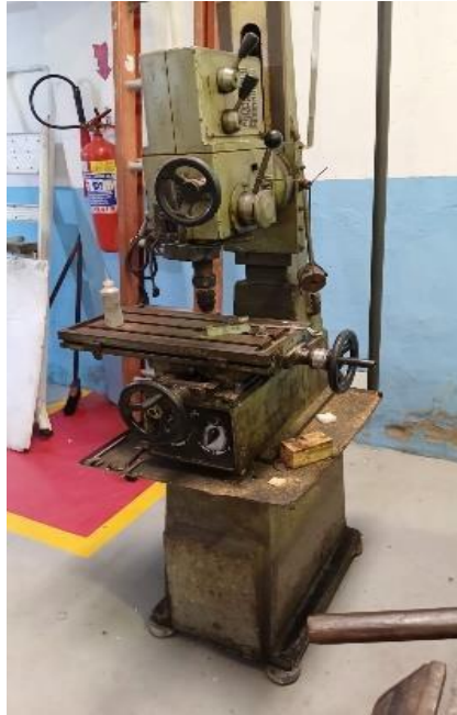
Figura 4 – Furadeira de Bancada com Mesa de Coordenadas Comercial
