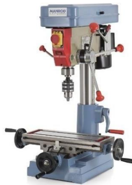
Figura 11 – Montagem ilustrativa da furadeira de bancada com mesa de coordenada
