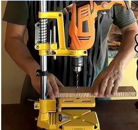
Figura 71 – Operação da furadeira de bancada
