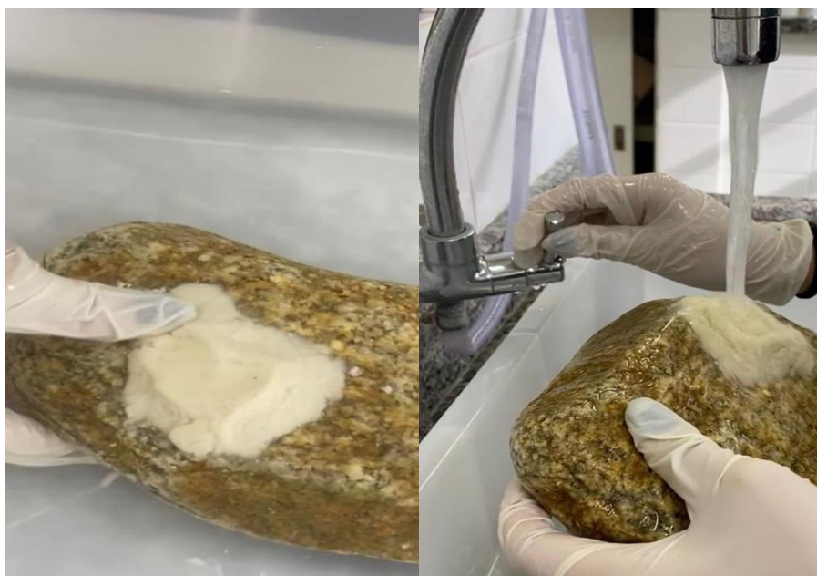
Figura 1. Teste em laboratório com a aplicação do produto sobre uma superfície rochosa (A). Teste de aderência utilizando um jato de água.
