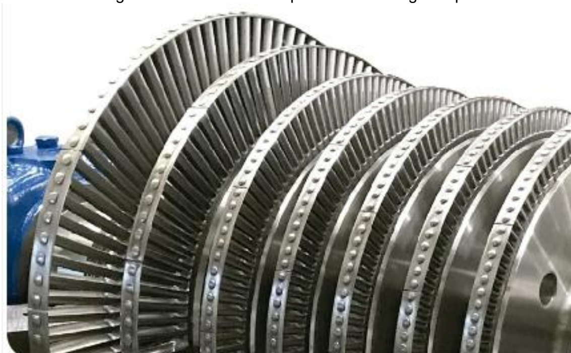
Figura 14. Turbina com as palhetas de estágio limpo
