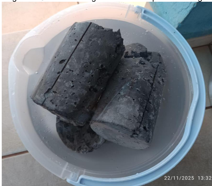
Figura 7. Concretos mergulhados em recipiente com água
