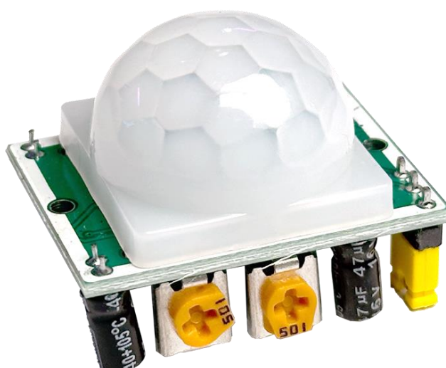
Figura 2: Sensor de movimento e acionamento (sensor PIR)
