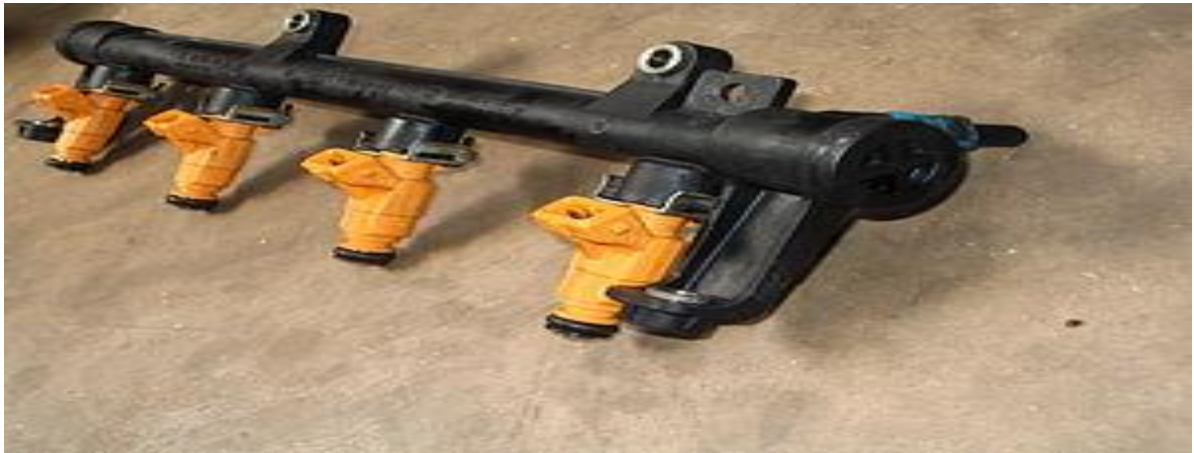
Figura3: Tubo distribuidor e injetores de combustível, usados nos modelos multiponto de injeção indireta
