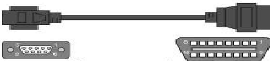
Figura 2.2: Cabo OBD2. (Extraído de ISO 15031-3:2006).
