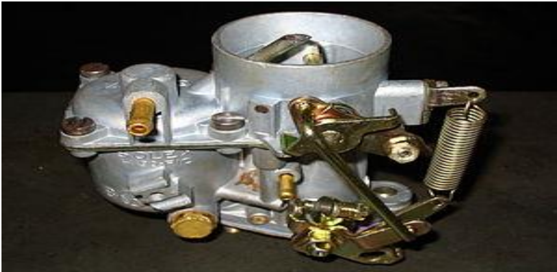
Figura 2:Carburador utilizado no Volkswagen fusca de 1970, no Brasil
