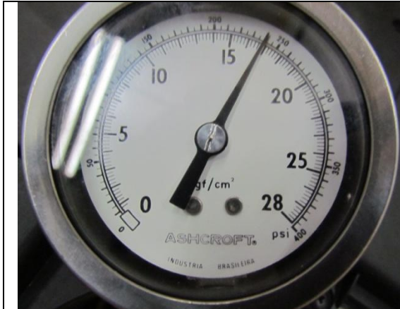
Figura 52. Manômetro utilizado no ensaio. Autor (05/10/2014).
