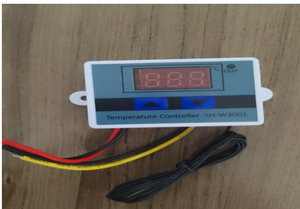
Imagem 2 - Termostato dig - Fonte: Autoria própria
