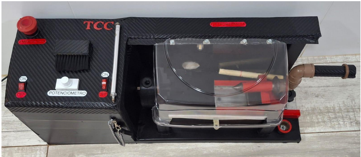
Figura 6 – Torno para madeira após montagem final Fonte: Elaborado pelo autor (2025)
