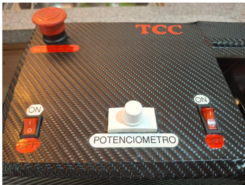
Figura 5 – Sistema de acionamento do torno Fonte: Elaborado pelo autor (2025)
