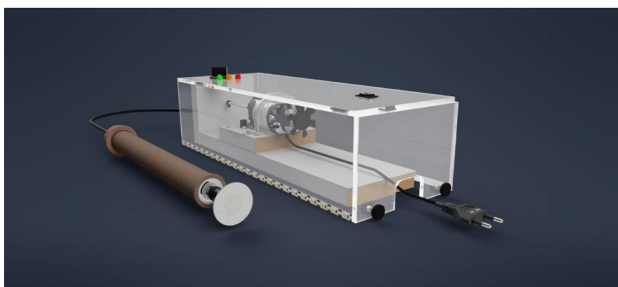
Figura 3: Cano de PVC que adaptado à base de MDF com acabamento acrílico Fonte: Arquivo pessoal
