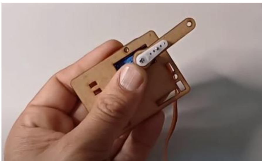
Figura 47 – Articulação I e Motor IV - União das peças
