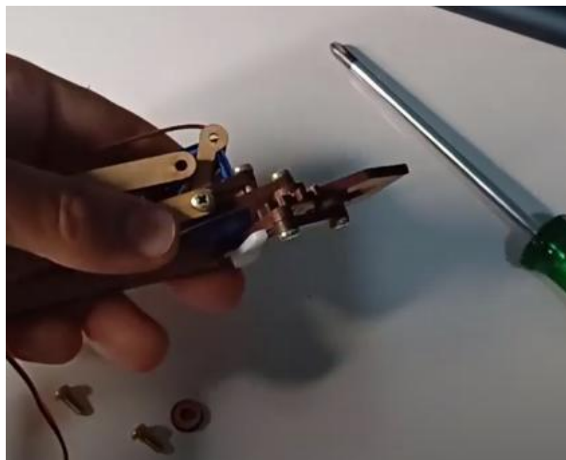
Figura 107 - Fixação concluída do lado direito da garra
