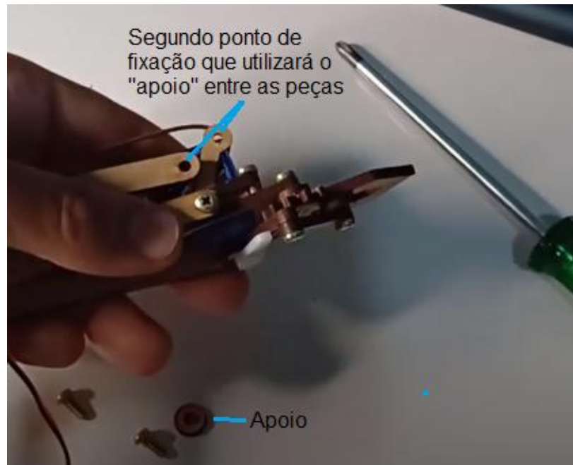
Figura 108 - Fixação do ponto superior
