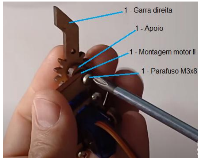
Figura 98 – Montagem da garra direita
