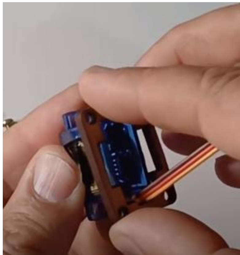
Figura 91 – Posicionamento do Suporte I no Motor II
