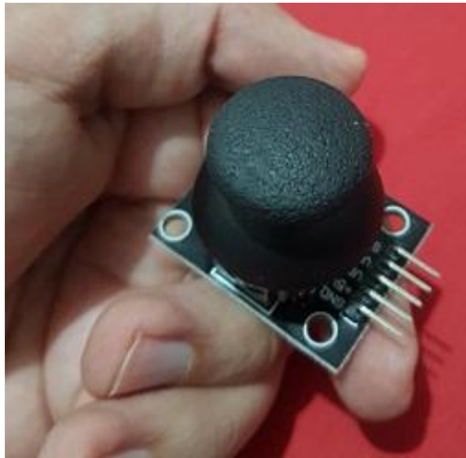
Figura 5 – Módulo Joystick KY-023
