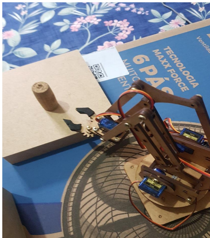
Figura 116 – Teste com rolhas de vinhos e revestimento emborrachado nas garras
