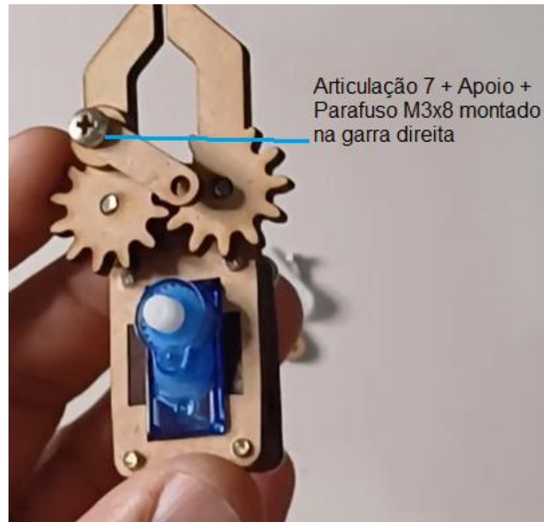
Figura 101 - Montagem da Articulação na Garra
