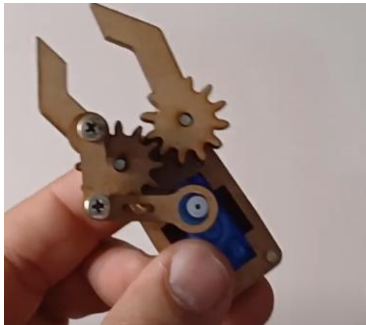
Figura 103 - Montagem das Articulações no Motor II
