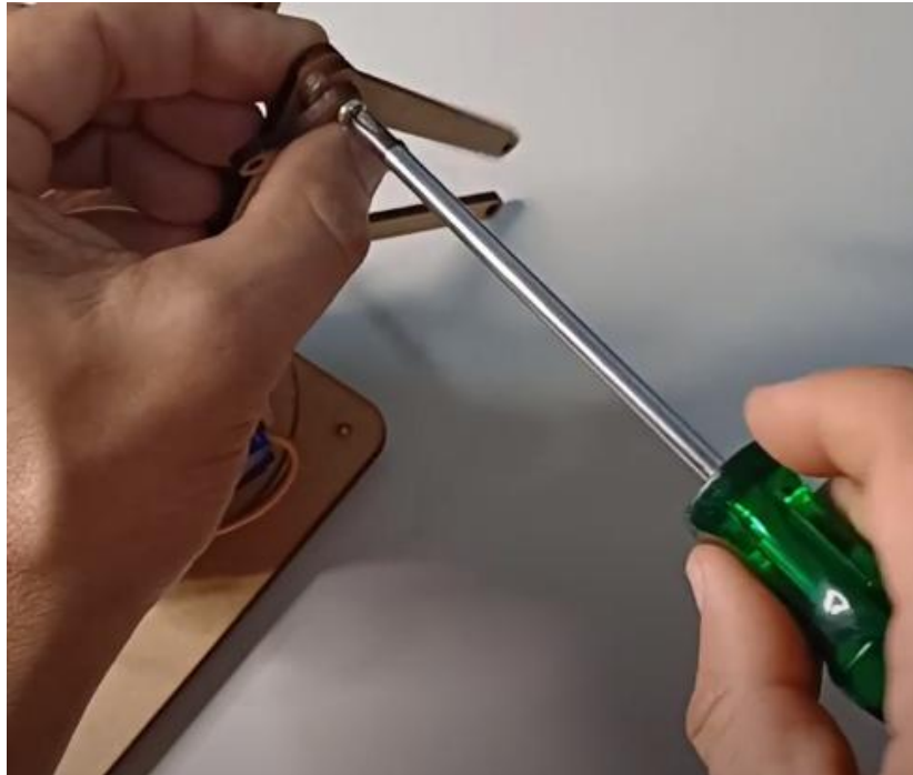
Figura 76 - Fixação da Articulação VIII e Fêmur na parte central do conjunto
