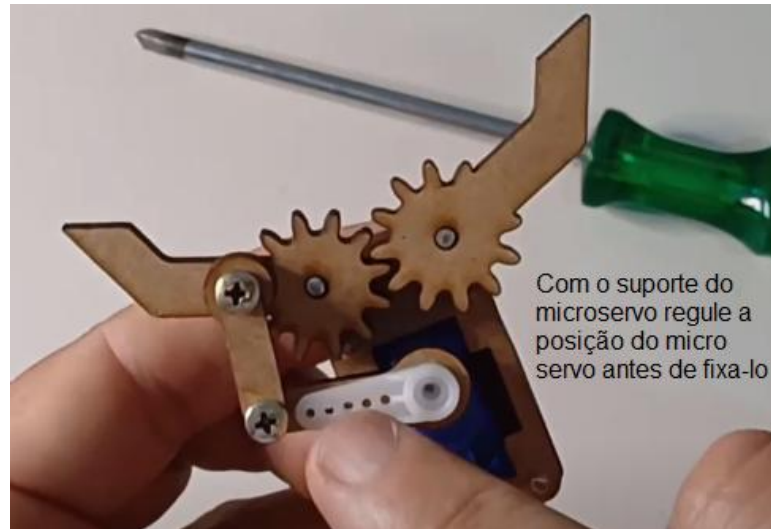
Figura 104 - Posicionamento e montagem do Suporte do Kit do Servo
