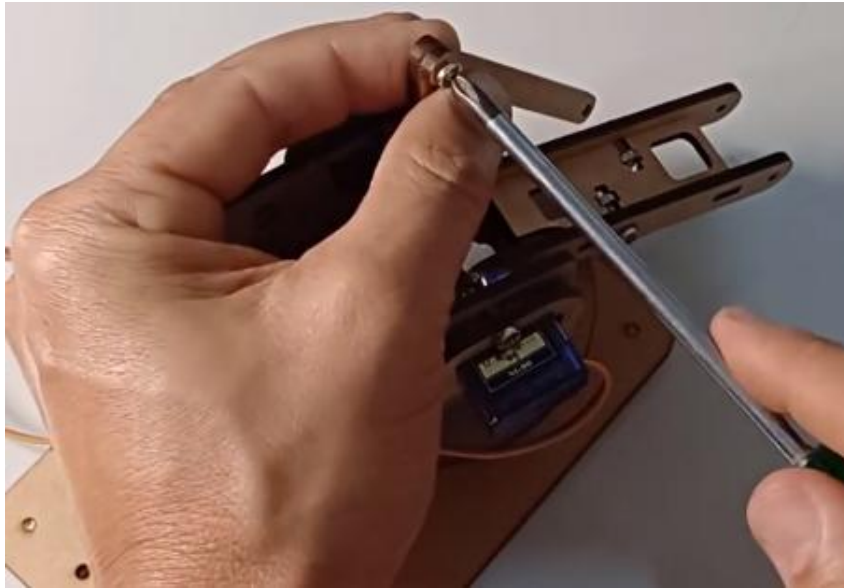
Figura 74 - Montagem da Articulação III na Articulação I do Motor IV
