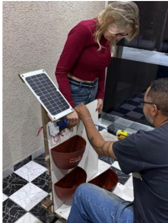
Figura 26: Fixação do suporte para vegetação no painel
