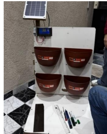
Figura 27: Fixação do suporte para vegetação no painel
