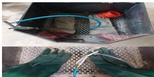
Figura 18 Antes e Depois da Parte interna da câmara de jateamento
