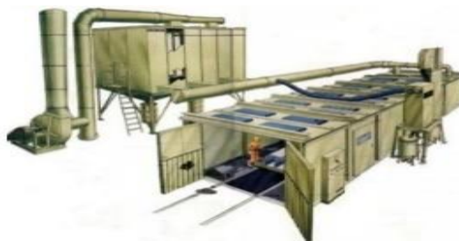
Figura 11 Cabina de jateamento por granalhas (Nortof)
