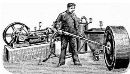
Figura 1 Processo de jateamento
