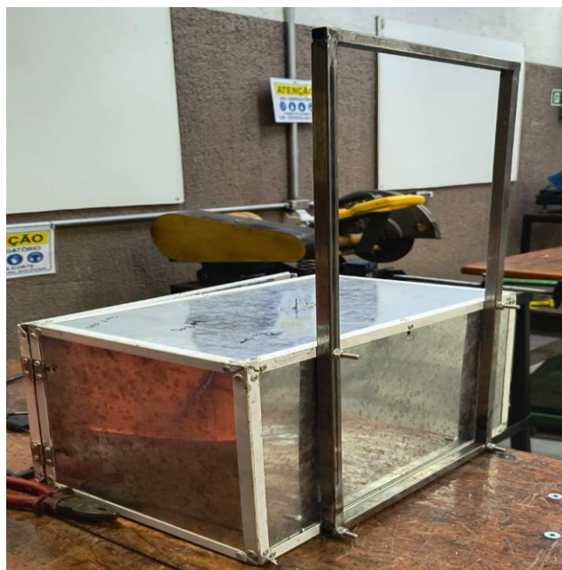
FIGURA 28 – Fixação da estrutura do painel elétrico FONTE: Do próprio autor, 2025
