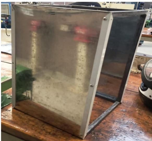
FIGURA 26 – Fixação das cantoneiras na estrutura FONTE: Do próprio autor, 2025
