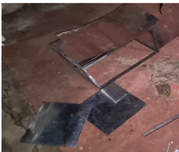
FIGURA 24 – Corte das chapas galvanizadas FONTE: Do próprio autor, 2025
