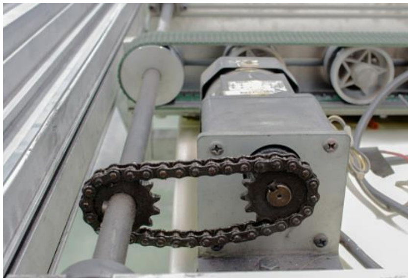
Figura 6: Conjunto de Acionamento
