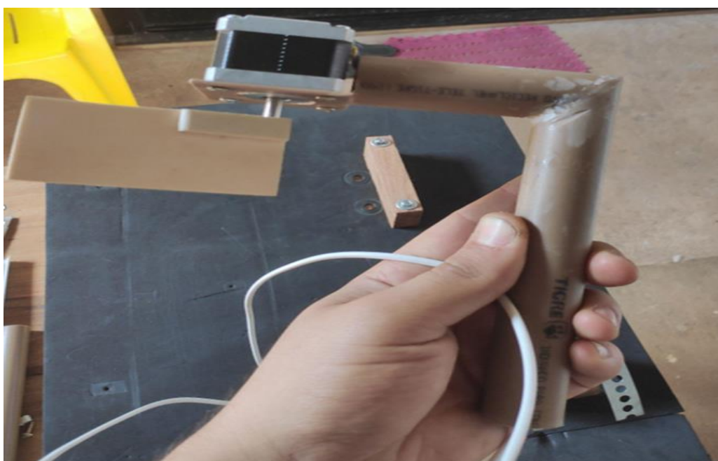
Figura 27: Suporte do motor de passo FONTE: Próprio Autor, 2025
