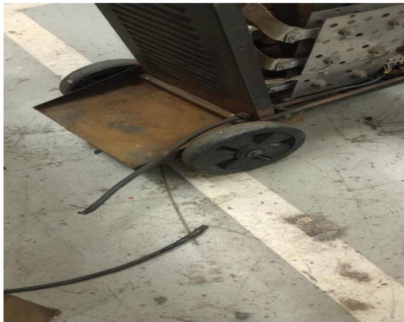
Figura 12: Cabo de alimentação rompido FONTE: Do próprio Autor, 2025
