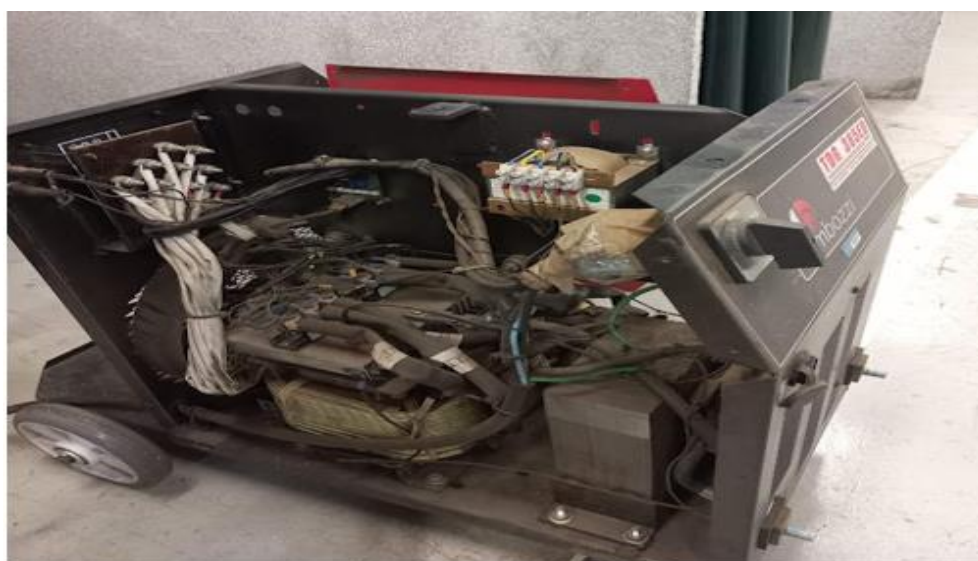
Figura 11: Máquina 1 antes de uma limpeza interna FONTE: Do próprio Autor, 2025
