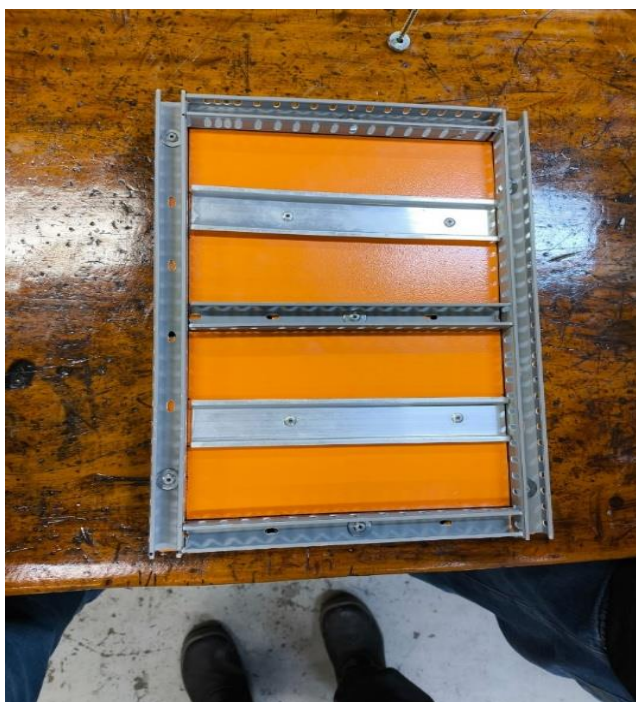
Figura 14: Bandeja com todos os trilhos e canaletas FONTE: próprio autor
