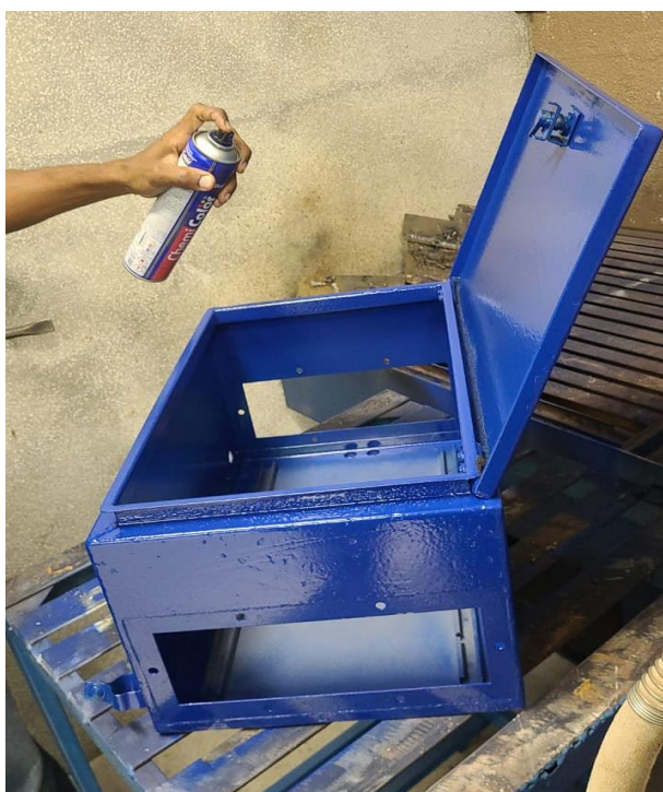
Figura 12: Pintura do painel antigo FONTE: Próprio autor, 2025
