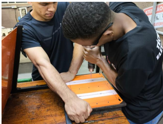
Figura 13: Perfuração da chapa do painel para a fixação dos trilhos FONTE: Próprio autor, 2025
