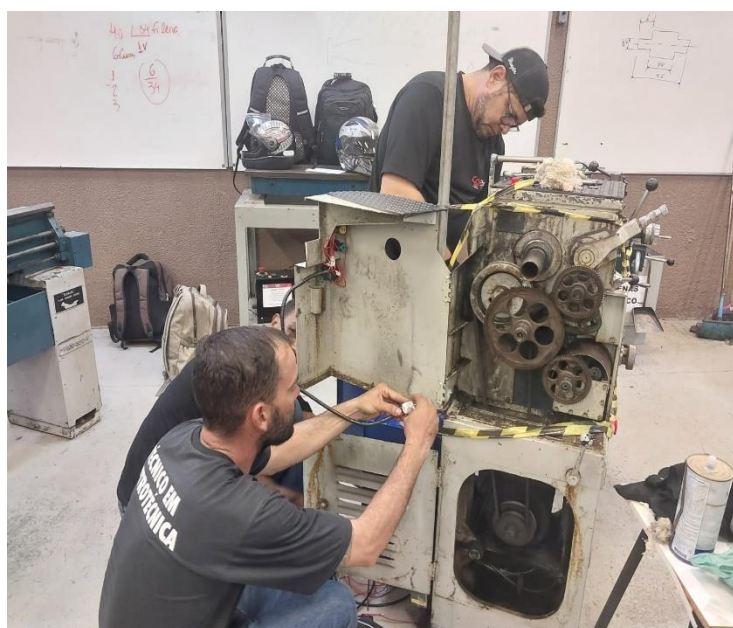
Figura 27: Crimpagem dos fios e passagem dos cabos. FONTE: Próprio Autor (2025).
