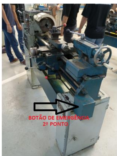
Figura 18: Segundo ponto de instalação do botão de emergência. FONTE: Próprio Autor (2025).
