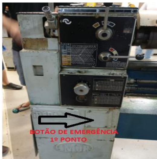
Figura 17: Primeiro ponto de instalação do botão de emergência. Fonte: Próprio Autor (2025).
