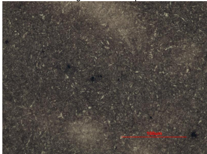
Figura 2. Microestrutura da Liga XD184. Ataque: Nital 2%. Aumento: 200x.
