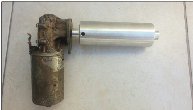
Figura 3.3 – Motor CC fixo ao rolete
