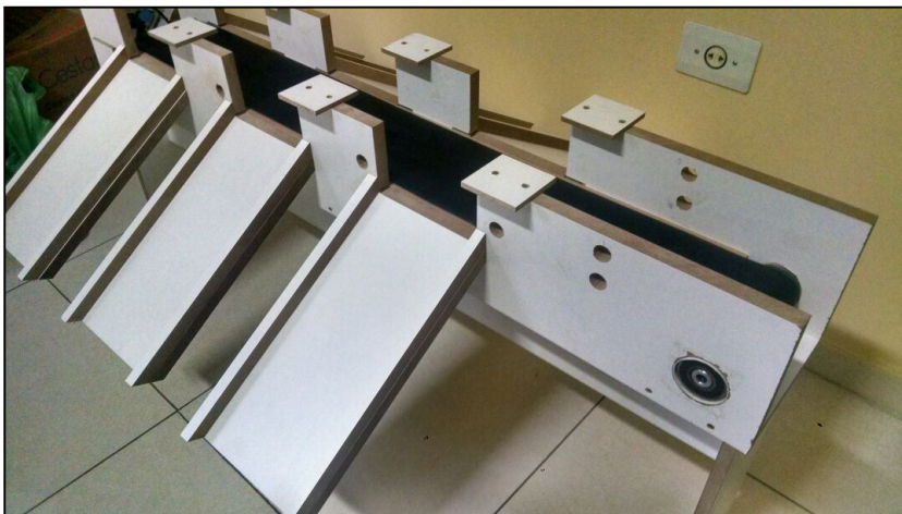
Figura 3.4 – Estrutura da esteira sem as pás
