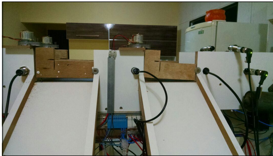
Figura 3.12 – Sensores fixos na estrutura da esteira
