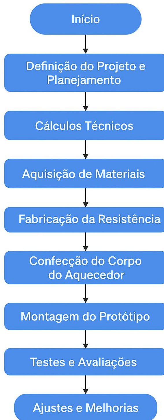
Figura 2: Fluxograma dos processos de execução do produto.
