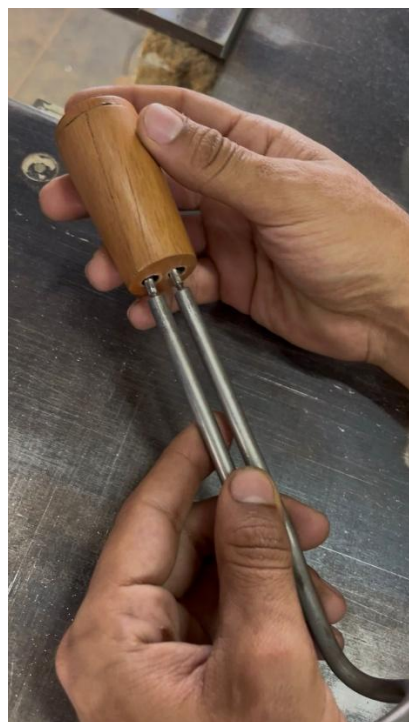
Figura 6: Montagem parte inferior do cabo.
