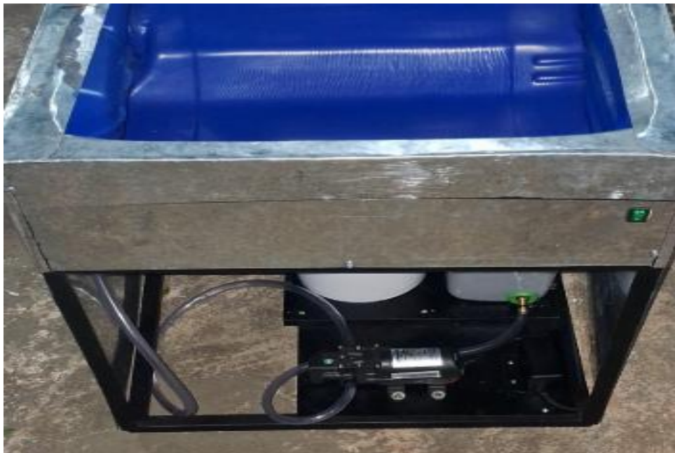
Figura 8-Finalização do lavador de peças.
