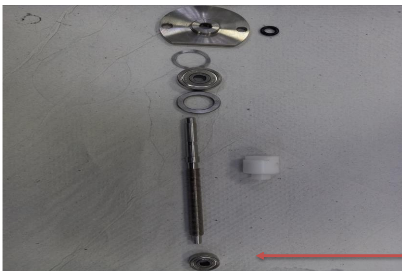
Figura 12 - Eixo de movimentação dos colimadores.
