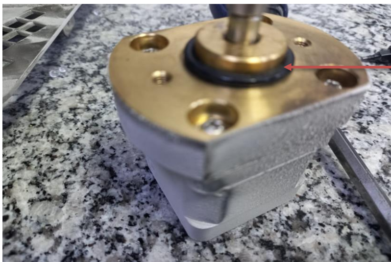
Figura 30 - Troca do anel do esticador.
