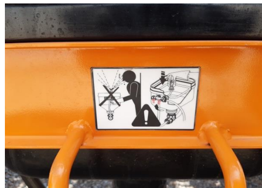
Figura 2- Adesivo indicando atenção, nunca acione a válvula do lavador de embalagens sem que a embalagem esteja devidamente posicionada sobre o bico aspersor – Fonte: Manual de Instruções UNIPORT 2000 Plus
