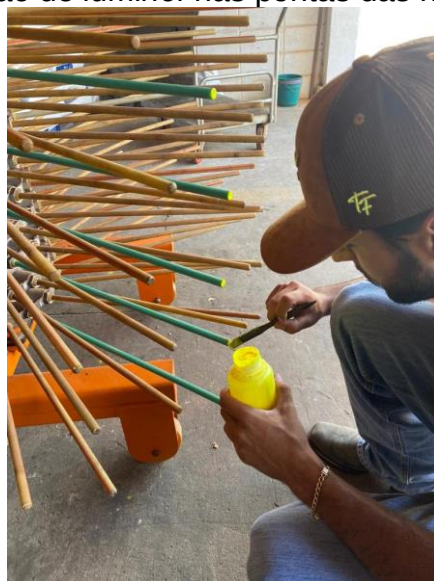
Figura 4 – Aplicação de luminol nas pontas das hastes derriçadoras
