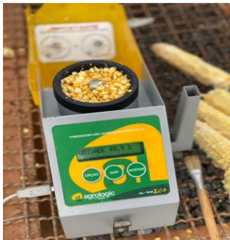
Figura 3. Medidor de umidade de sementes portátil utilizada para determinar o ponto de coleta final de dados.
