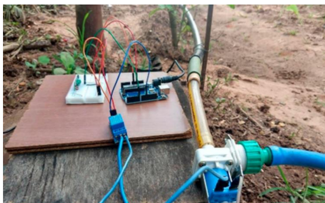
Figura 7. Placa Arduino com a válvula solenoide posicionada na linha de cultivo
