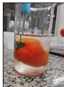
Figura 8: Reticulação do alginato de sódio
