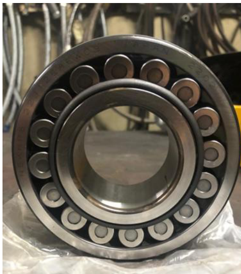
Figura 8 – Rolamento 22312 utilizado na turbina
