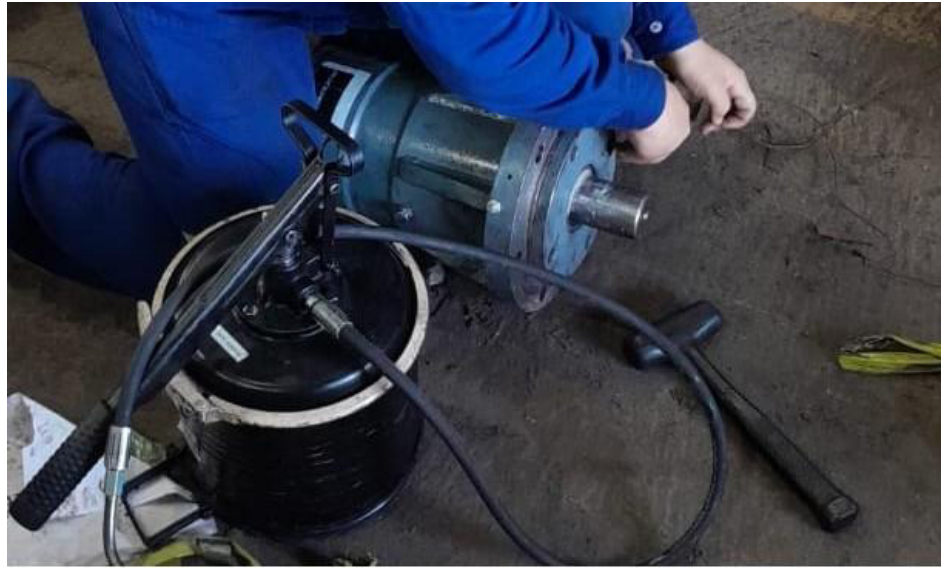
Figura 33 - Lubrificação antes da montagem do conjunto da turbina
