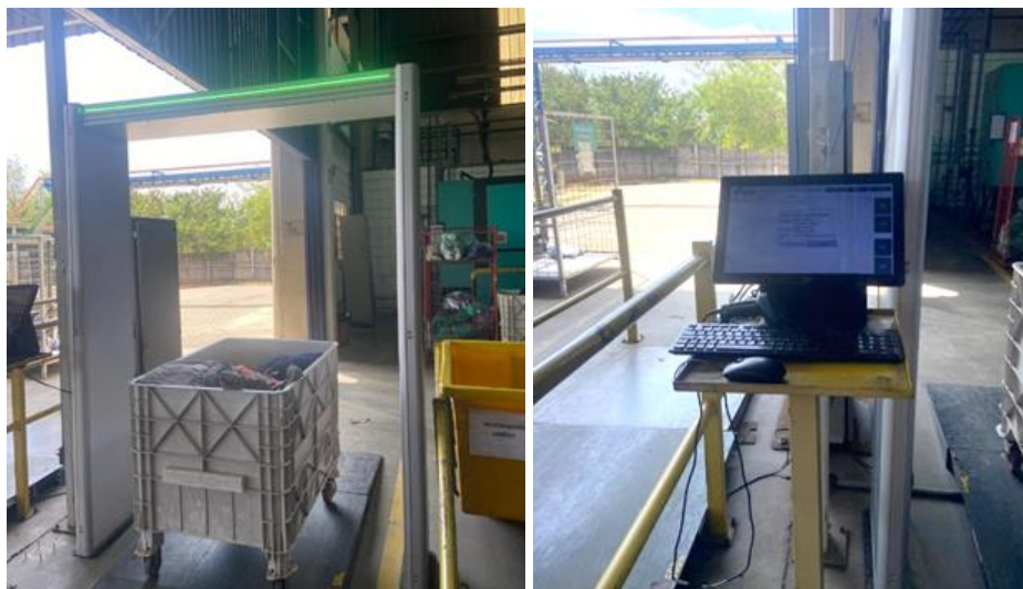
Figura 22 – Porta de leitura dos chips para rastreabilidade de uniformes e totem de leitura e conferência de dados do portal eletrônico de identificação de uniformes
