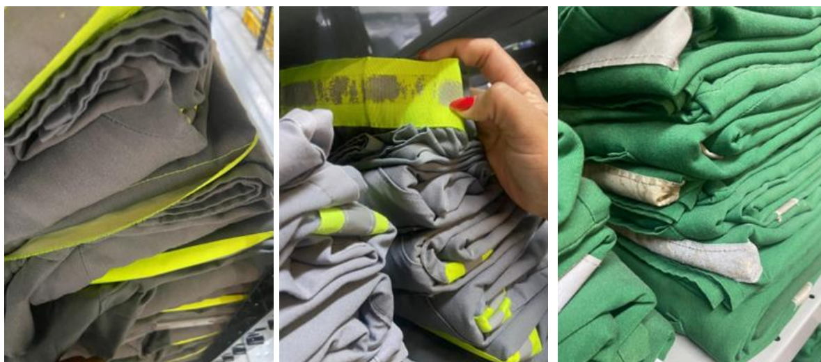
Figura 23 – Amostra de defeitos ocorridos nas faixas refletivas
