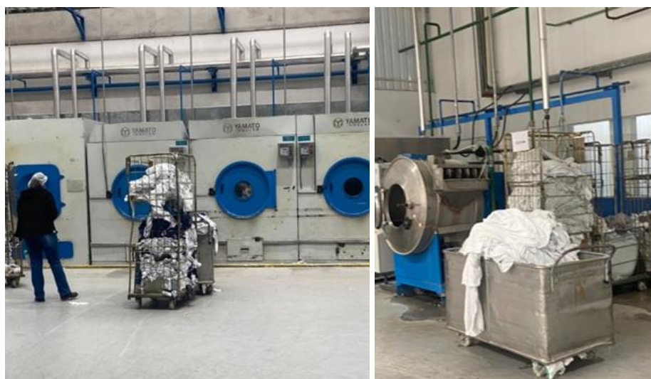
Figura 19 – A área suja e as extratoras para higienização com as peças separadas nos carrinhos de acordo com os processos de lavagem
