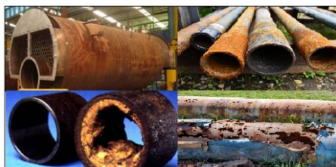
Figura 1: Caldeira e canos metálicos corroídos
