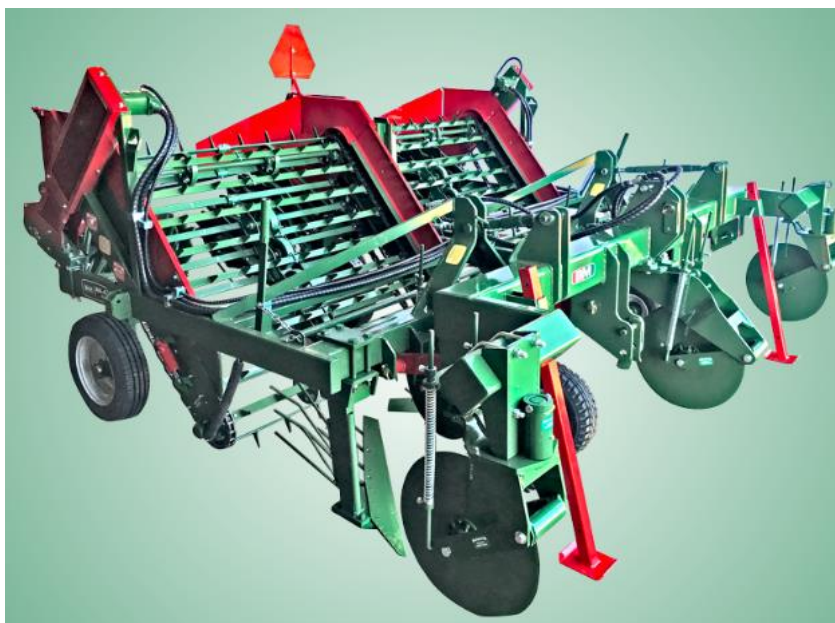
Figura 3 - Arrancador Pantográfico de Amendoim – AIA KBM 4L Flex – 4 linhas
