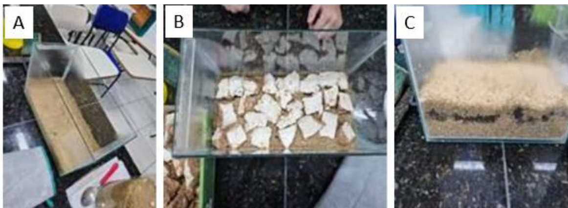
Figura 8. Montagem do experimento no aquário. A- Primeira camada: de serragem enriquecida com borra de café; B- Segunda camada: substratos do fungo Pleurotus ostreatus em pedaços; C- Terceira camada: terra contaminada com acetato de chumbo, mais serragem enriquecida com borra de café. Fonte: Autoral, 2025
