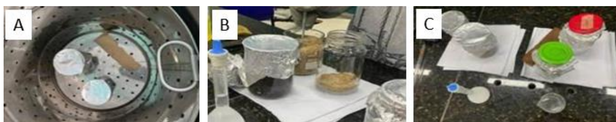
Figura 9. Procedimentos de preparo para teste e controle. A- Autoclave dos materiais; B- Montagem dos meios com controle e teste; C- Materiais prontos. Fonte: Autoral, 2025
