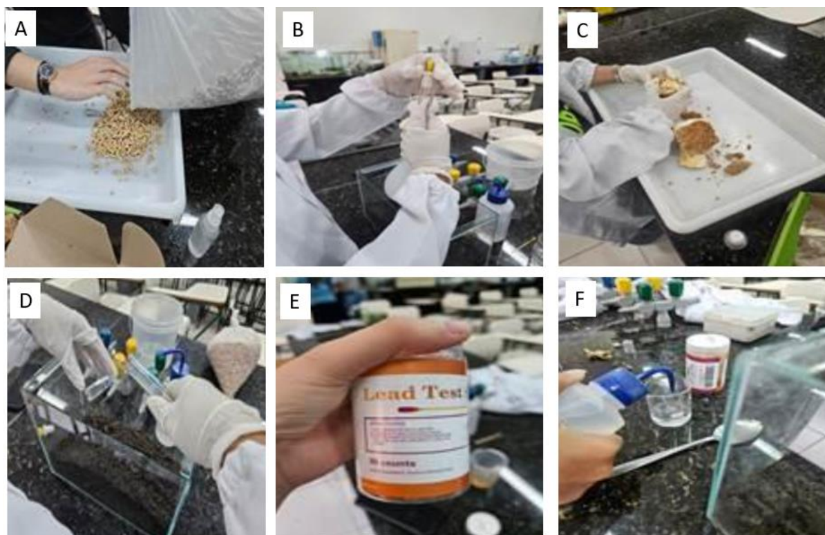
Figura 6. Preparo da prática de crescimento de Pleurotus ostreatus em solo contaminado. A- Maceração da serragem; B- Separação do substrato; C- Preparo de solução de acetato de chumbo; D- Mistura da terra com acetato de chumbo; E- Teste de chumbo; F- Diluição do solo após preparo para teste de contaminação. Fonte: Autoral, 2025
