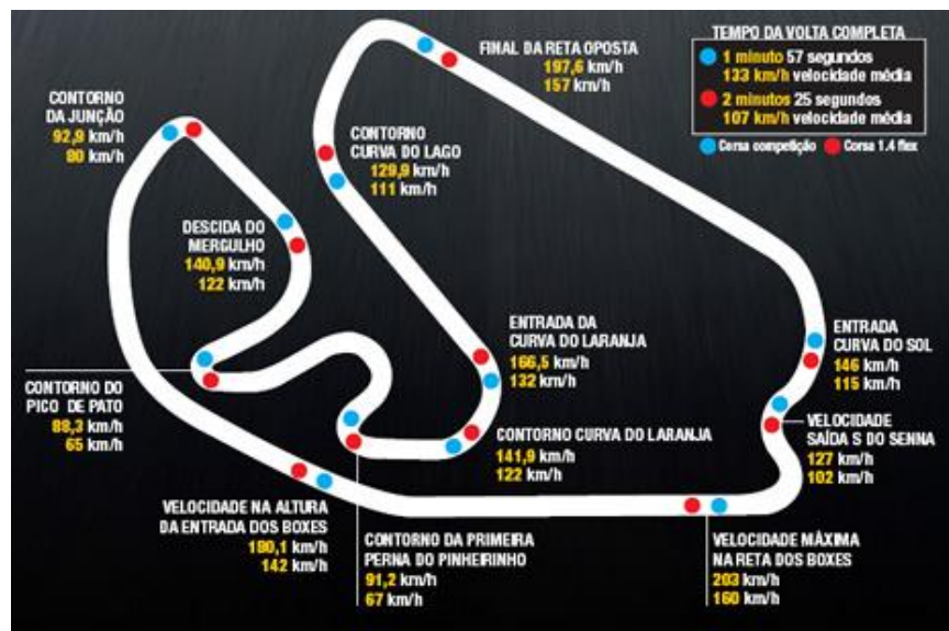
Figura 22 - Velocidade máxima atingida por 2 Corsas em diferentes pontos da pista, conforme medições realizadas pela Motor Show (EDITORA TRÊS, 2009)
