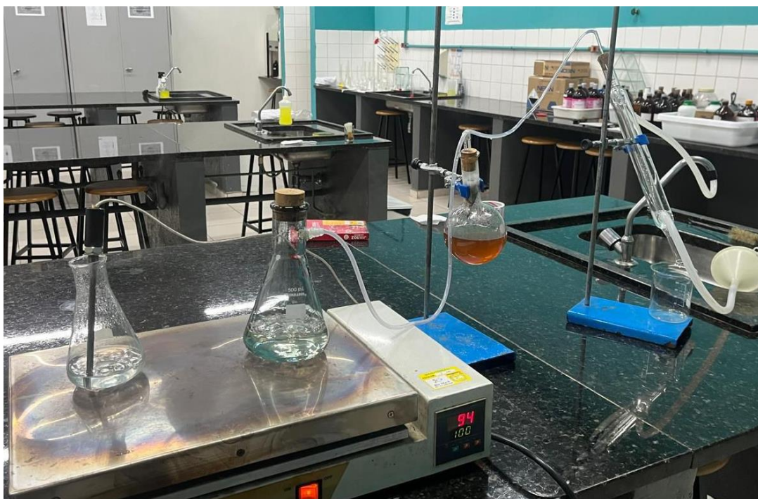
Figura 4. Esquema de montagem de vidrarias para extração de óleo de borra de café. Fonte: autoral, 2025
