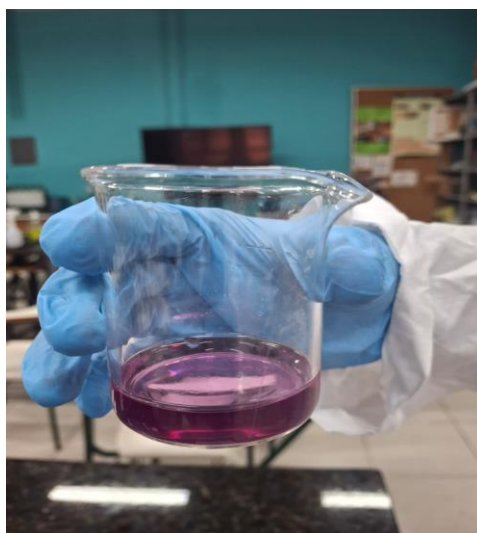
Fig. 6: Béquer com reagente “rodizonato de sódio” em água destilada, com mudança de coloração para roxo indica presença de chumbo. Fonte: Autoral, 2025.
