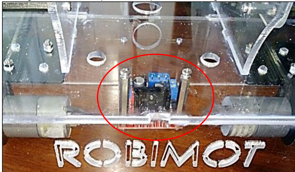
Figura 3.8 – Placa de ponte “H” acoplada ao robô e ligado aos motores
