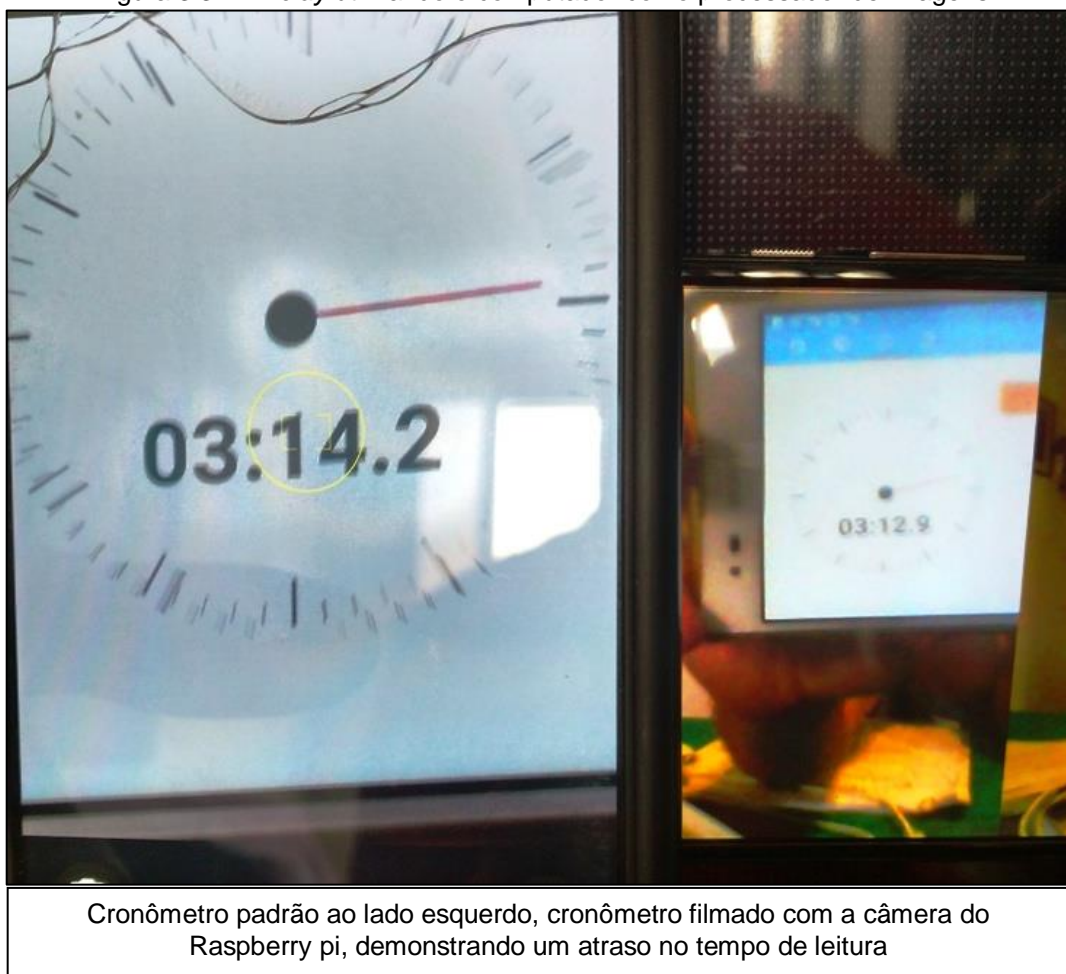
Figura 3.32 – Delay utilizando o computador como processador de imagens
