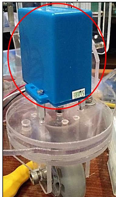
Figura 3.13 – Novo servomotor acoplado ao eixo e à estrutura
