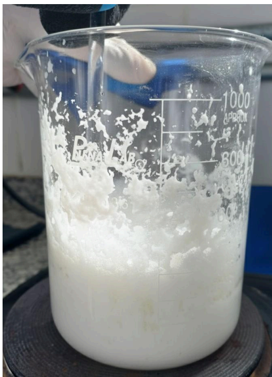
Figura 4: Aquecimento da fase oleosa em béquer para a solubilização dos componentes da fórmula.
