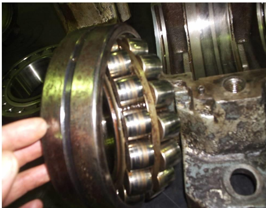
Figura 16 Rolamento do mancal, componente que apresentou a falha. (do autor)
